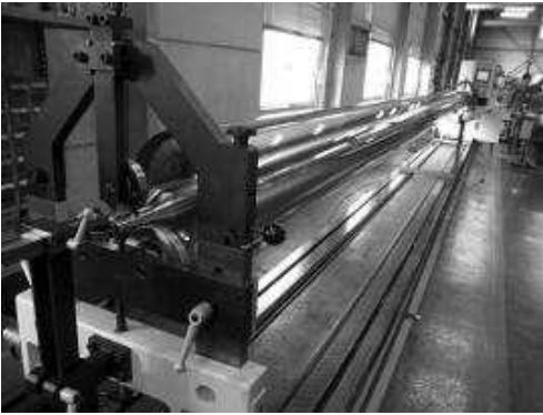
図 10 φ350×9,200mmL ロール 高速回転テスト風景
