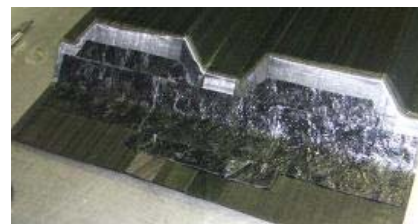
CF-SMCとNet Shape プリフォームを同時にチャージ
