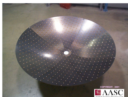
きく 8 号アンテナ地上展開試験
