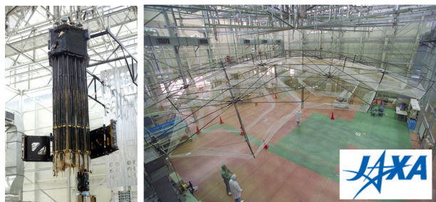
きく 8 号アンテナ地上展開試験
